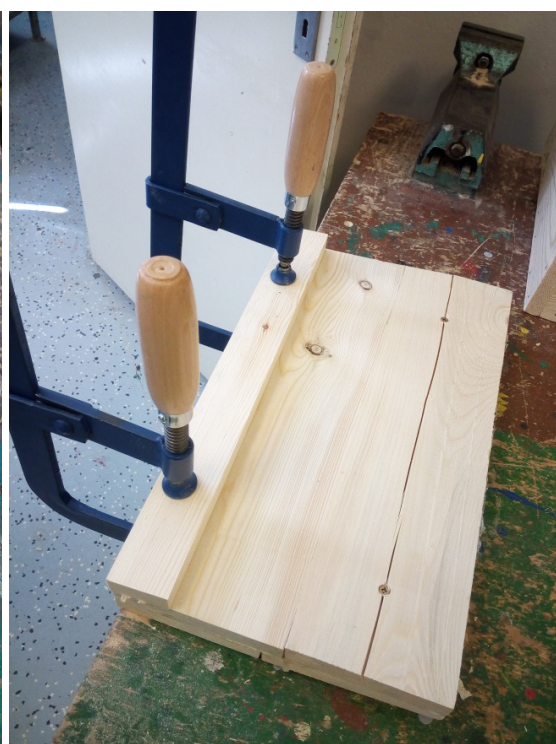
zatlukání malých hřebíků spojování dřeva lepením s pomocí ztužidel
