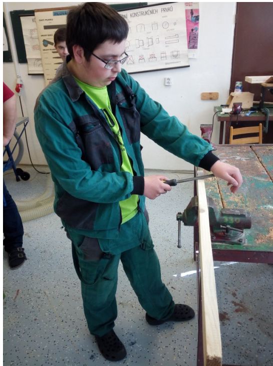
správné držení pily správné držení pilníku (rašple)
