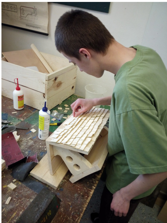
polepování krmítka (imitace dřevěného šindele)
