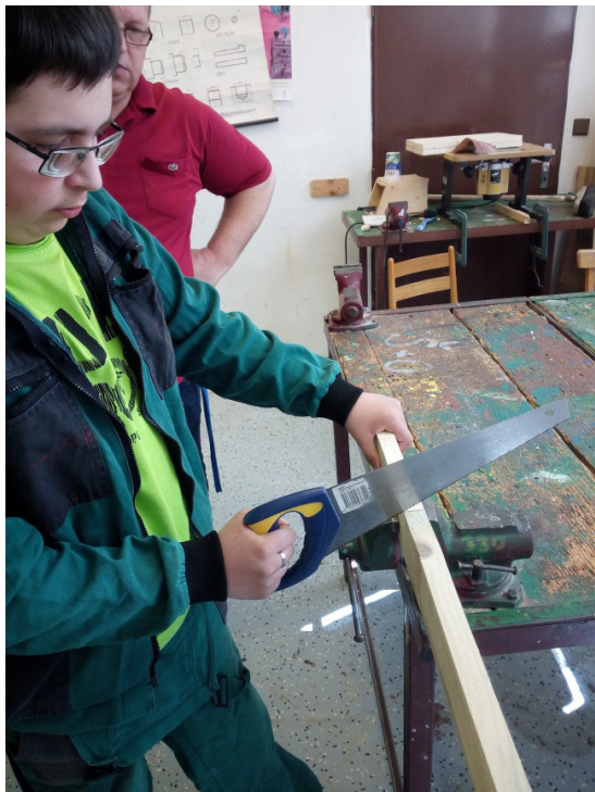
správné držení pily správné držení pilníku (rašple)
