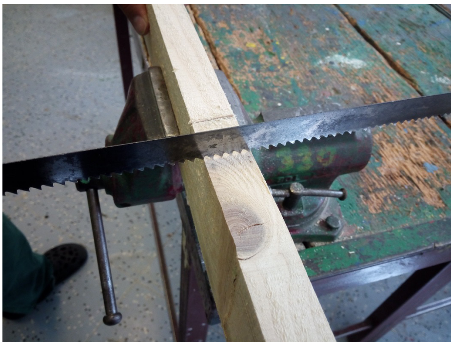
správné postavení zubů při řezání rámovou pilou
