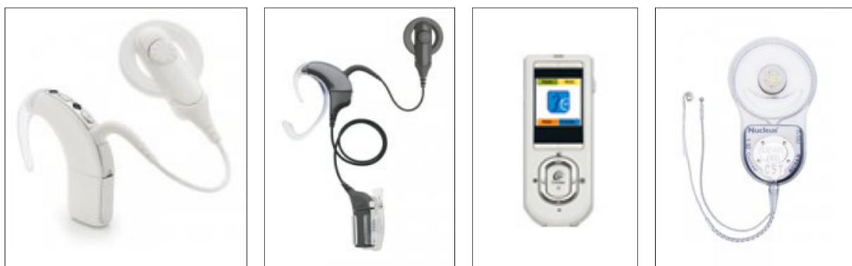
Obr. zleva: Řečový procesor s cívkou, řečový procesor s cívkou a s úchytem na oblečení proti ztrátě, dálkový ovladač k řečovému procesoru, vnitřní část implantátu, kterou má pacient voperovanou v hlavě za uchem; systém Cochlear
