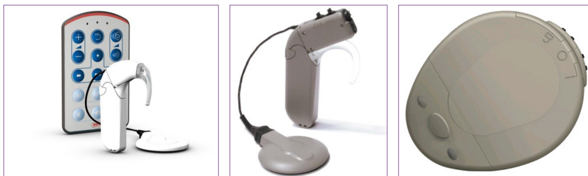
Obr.: zleva: Varianty vnějších částí – řečové procesory, novinka – RONDO – oproti předešlým typům řečových procesorů je nově vše (řídící jednotka, baterie, vysílací cívka) v jednom kompaktním pouzdře, žádné další části uživatel nenosí; systém Med-el
